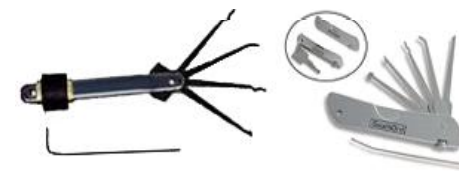
Рис. 51. Отмычки, изготовленные из пластин
