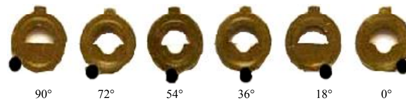
Рис. 40. Расположение выемок на основных шайбах
