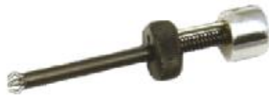
Рис. 53. Отмычка для отпираания крестообразных цилиндрических механизмов
