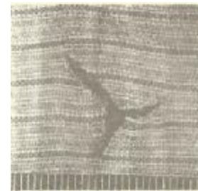
Рис. 111. Повреждение в виде трехлучевой звезды, образованное трехгранным клинком
