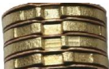
Рис. 42. Расположение ложных выемок на шайбах
