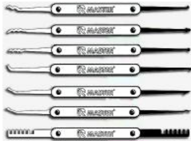
Рис. 52. Универсальный набор отмычек для отпираания цилиндрических замков
