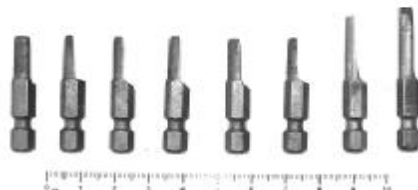
Рис. 67. Биты для дрелей, переделанные под свертыши для взлома цилиндрических замков типа «Аблой»
