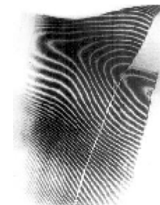
Рис. 87. Интерференционная картина совмещения признаков внутреннего строения осколков стекла (получена в лучах лазера)
