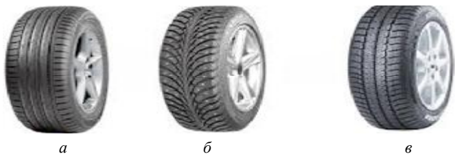
Рис. 98. Рисунок беговой дорожки протектора, соответствующий сезону использования шины: а – летний; б – зимний; в – всесезонный
