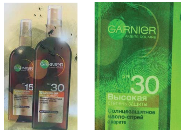
Рис. 3. Многоцветная поверхность (обложка журнала), обработанная флуоресцентным дактилоскопическим порошком (слева), применение УФ-осветителя для выявления невидимых следов рук (справа)
